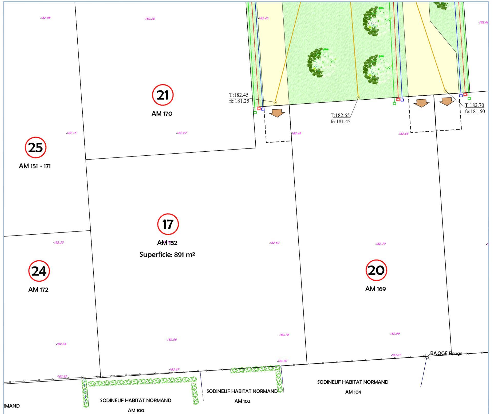
Les cotes de niveaux, la position des réseaux et des branchements sont données à titre indicatif et pourront être modifiées au cours des travaux.
