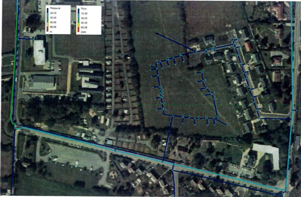
Figure 7 : Simulation d'un tirage de 60 m<sup>3</sup>/h sur l'hydrant N°22
